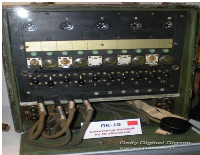
Полевой коммутатор ПК-10 на десять абонентов
